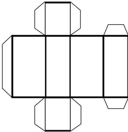
Un possibile sviluppo per un parallelepipedo. Potete indicare gli altri? Quanti sono? (4)
