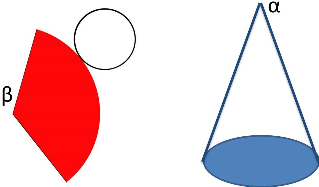
Che relazione c'è tra l'angolo del cono  $\alpha$  e l'angolo del suo sviluppo  $\beta$ ? (10) (nota: la soluzione richiede una minima conoscenza di trigonometria piana)
